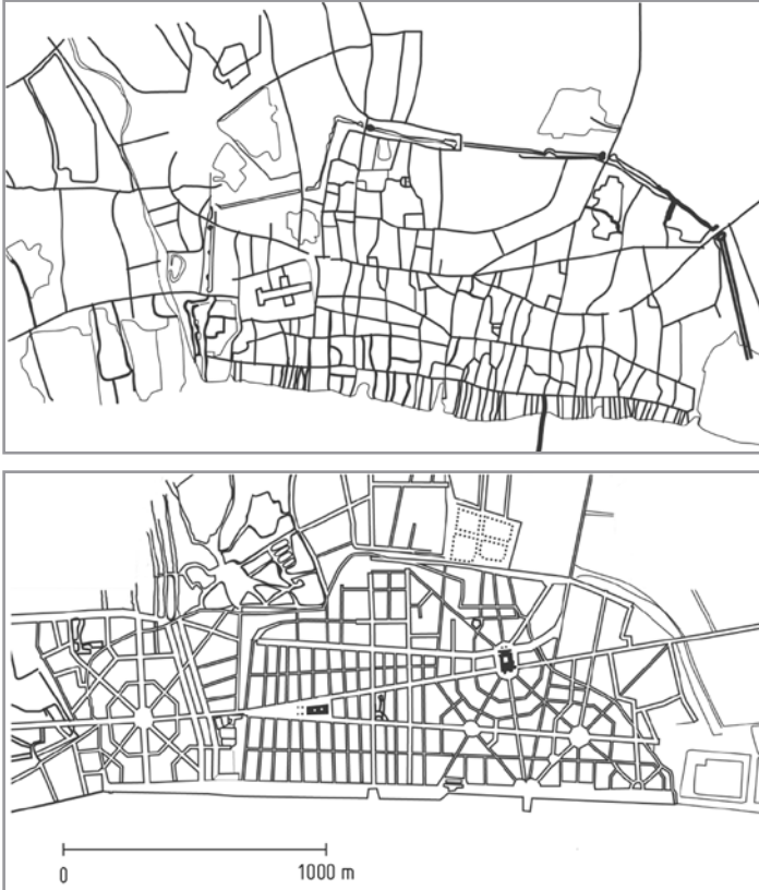
Ryc. 111. Londyn – miasto dotknięte wielkim pożarem w 1666 roku. U góry struktura miasta sprzed pożaru; na dole projekt odbudowy zakładający wprowadzenie założeń osiowych i ciągów placów oraz porządkowanie zabudowy, Ch. Wren. Projekt niezrealizowany.
