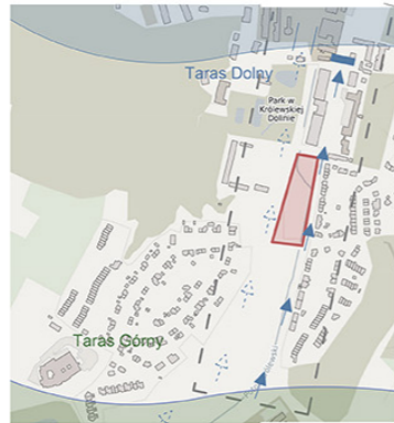
SCHEMAT PRZEPŁYWU POWIETRZA LEGENDA: - - - - - lokalizacja terenu projektowanego - - - - - obszar Królewskiej doliny - - - - - przepływy powietrza - - - - - zakładany przepływy powietrza - - - - - przepływy powietrza okalający przez wysoką zabudowę biurową Politechniki Gdańskiej
