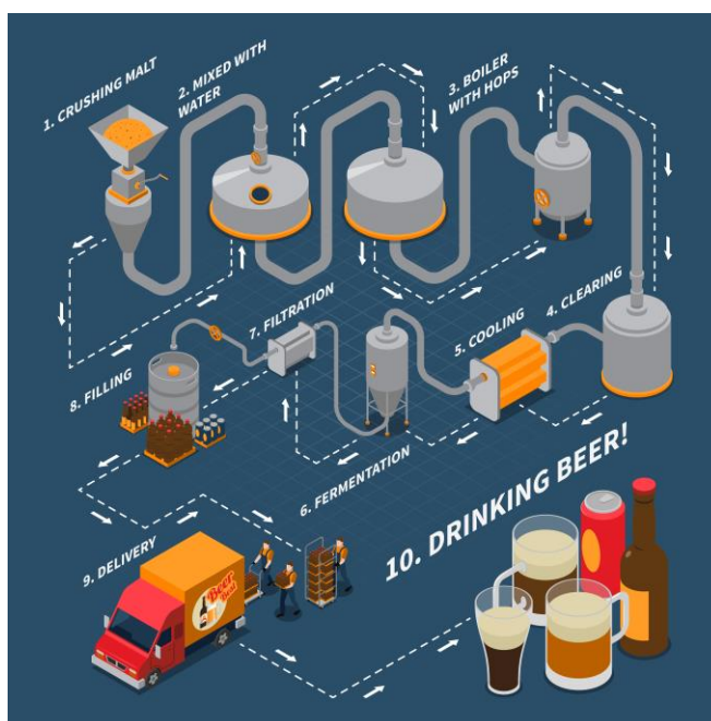
Ilustracja 3.4.12. Etapy produkcji piwa ( https://pl.freepik.com ) Schemat na planszy nr 3 opracowano na podstawie powyższego źródła
