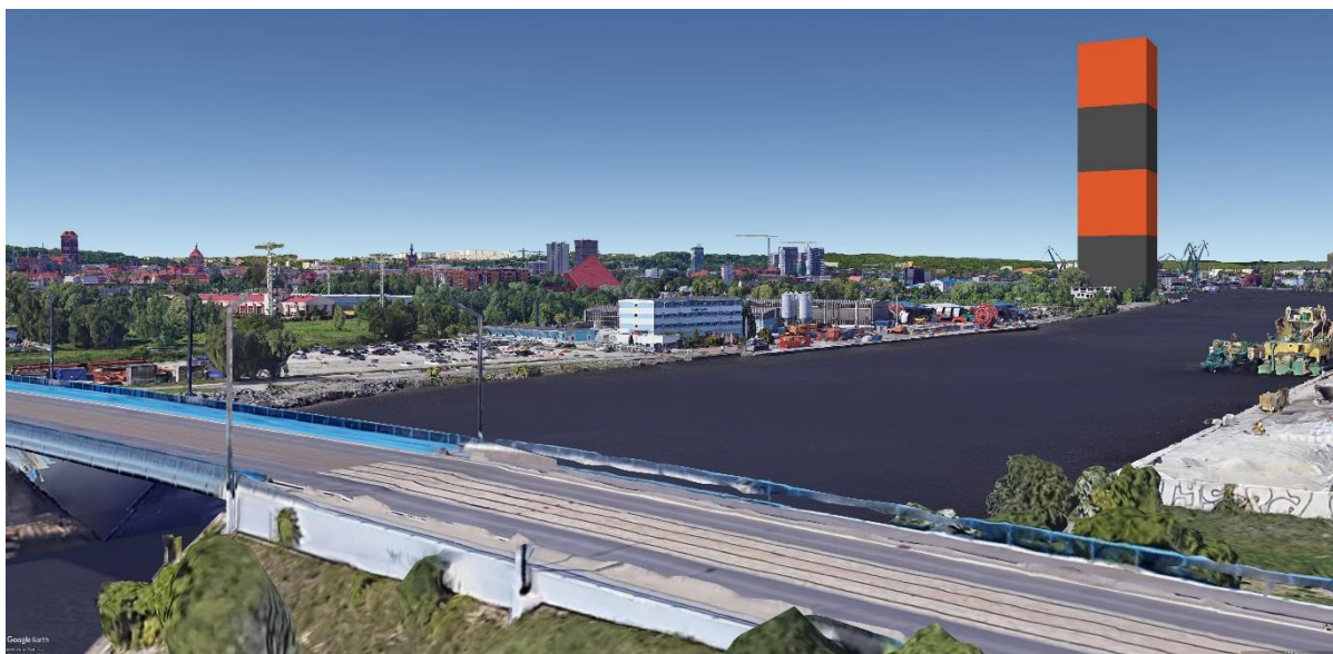
Rysunek 26 Symulacja trójwymiarowa implikacji potencjalnej kubatury nowego wieżowca na Polskim Haku. Model ma wymiary podstawy 50 na 50 metrów i wysokość oznaczoną w zmiennym kolorze co 50 metrów do 200 metrów wysokości względnej od poziomu terenu.
