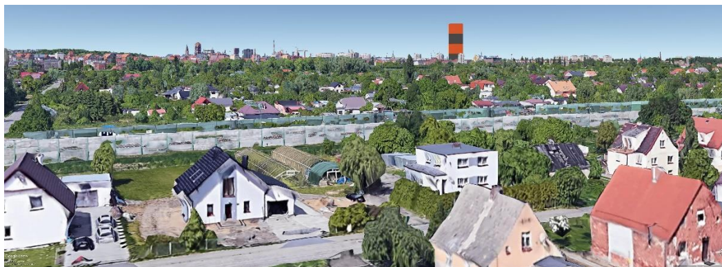
Rysunek 30 Symulacja trójwymiarowa implikacji potencjalnej kubatury nowego wieżowca na Polskim Haku wykonana z obszaru Oruni Równej przy Trakcie św. Wojciecha. Model ma wymiary podstawy 50 na 50 metrów i wysokość oznaczoną w zmiennym kolorze co 50 metrów do 200 metrów wysokości względnej od poziomu terenu.
