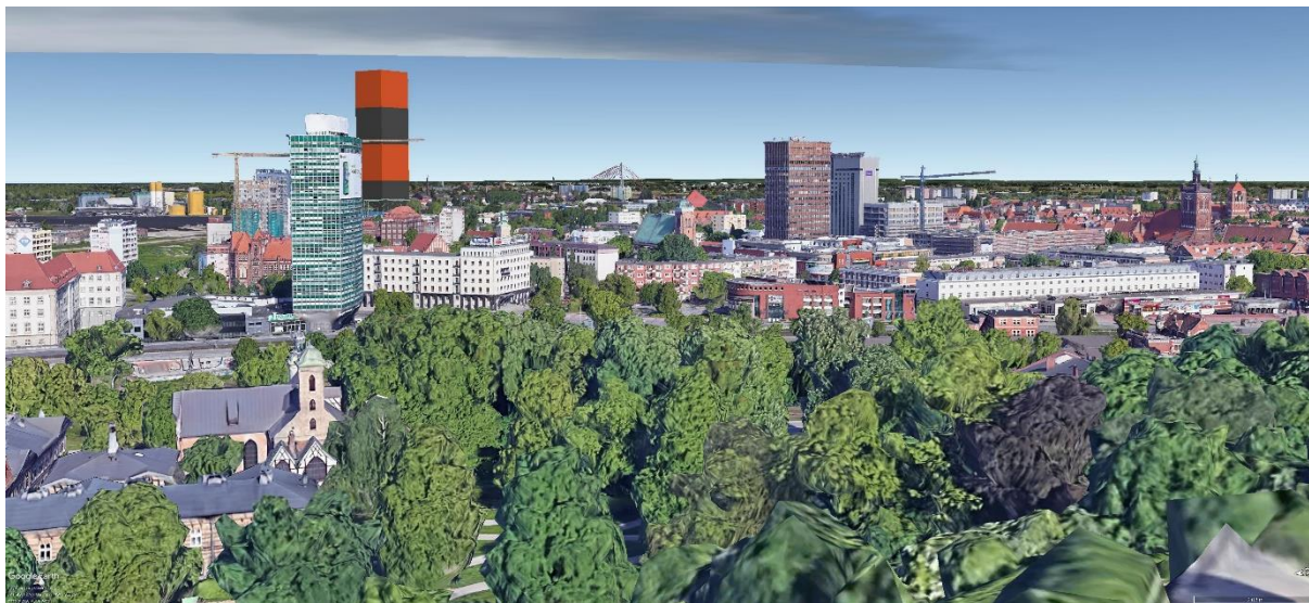
Rysunek 28 Symulacja trójwymiarowa implikacji potencjalnej kubatury nowego wieżowca na Polskim Haku. Model ma wymiary podstawy 50 na 50 metrów i wysokość oznaczoną w zmiennym kolorze co 50 metrów do 200 metrów wysokości względnej od poziomu terenu.
