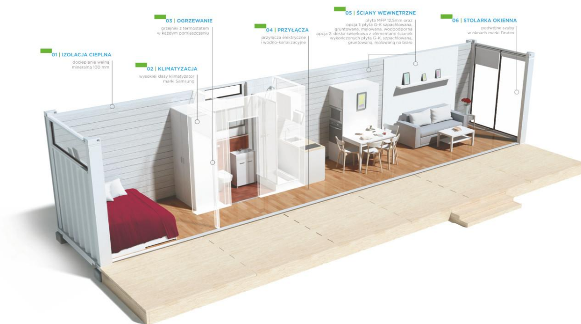
Ryc. 30. Przykładowy projekt domu kontenerowego autorstwa ECO CONTAINERS
