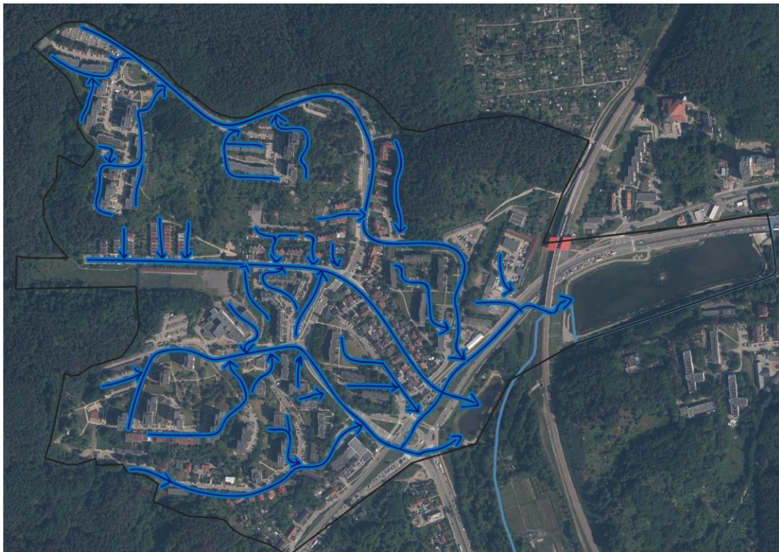
Rys 5.23 Schemat spływu wód opadowych na osiedlu Niedźwiednik. Opracowanie własne.
