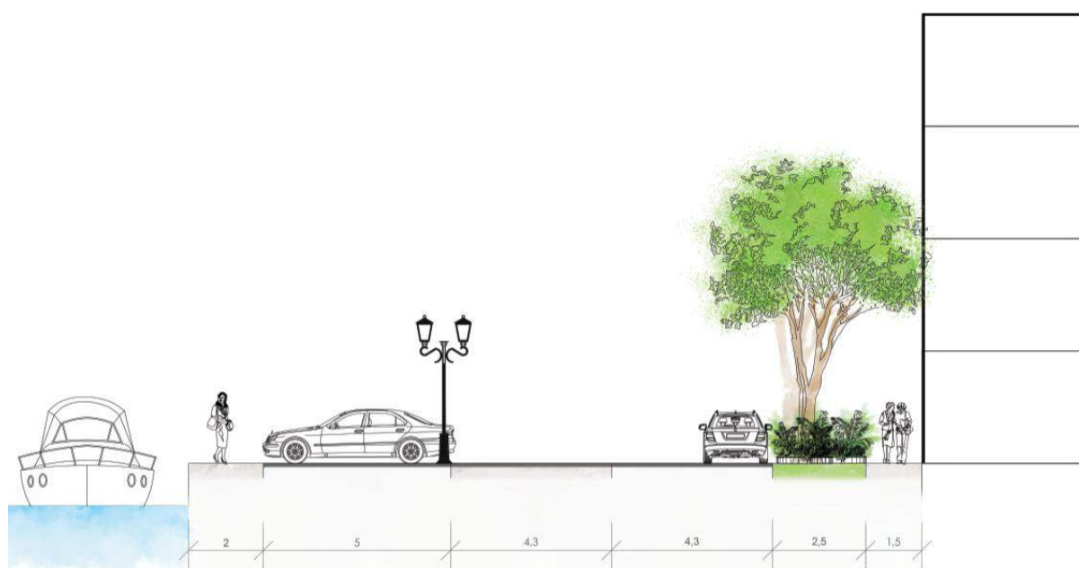
Ryc. 6.36. Przekrój Bulwaru Portowego źródło: opracowanie własne
