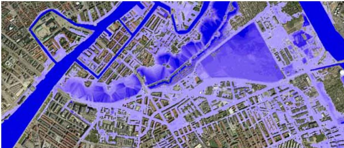
Rysunek 3.5. Zasięg wody w przypadku wzrostu poziomu morza o 226 cm – zdarzenie statystycznie pojawiające się raz na 20 lat w 2110 r. (źródło: City of Copenhagen, 2011, s. 33).
