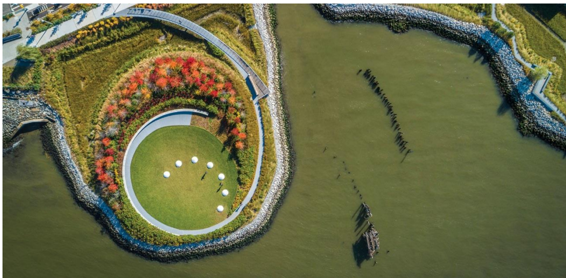
Rysunek 4.9. Zrównoważone podejście do projektowania waterfrontu – ochrona brzegu połączona z dostępnością (wyniesione ciągi prowadzące do przestrzeni publicznej nad samą wodą) oraz ochroną siedlisk dzikich gatunków słonowodnych na obszarze zalewowym (źródło: American Society of Landscape Architects, 2019; dostęp: 27.07.2020 r.)
