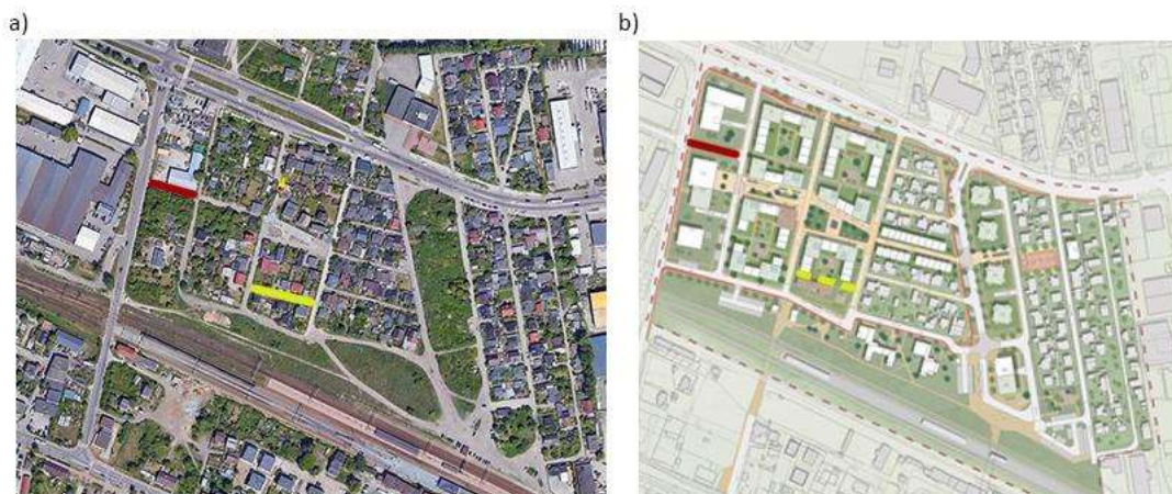
Rys.63. Zmiany w układzie drogowym, a) stan istniejący- czerwony-przebieg ulicy śliwkowej, żółty-ulica Morelowa; b) stan projektowany, czerwony-zmieniony przebieg ulicy śliwkowej, żółty-dawny przebieg ulicy Morelowej. Opracowanie własne.
